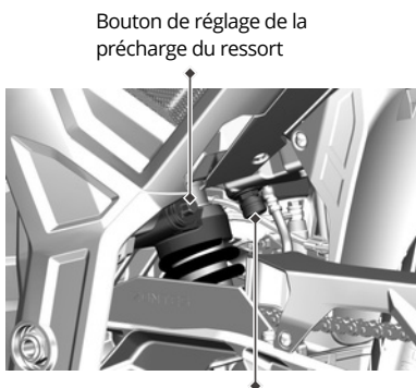
Bouton de réglage de l'amortissement en compression de l'amortisseur
